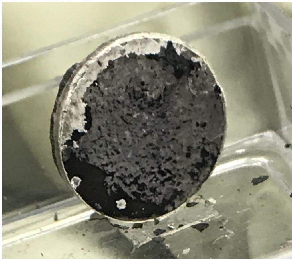
コイン型テストセル(ハーフセル)の外観
